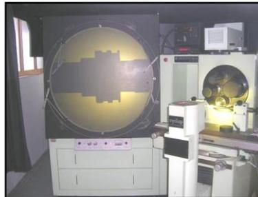
Wir verfügen über die notwendigen Messgeräte und Geräte um die von unseren Kunden geforderte Qualität sicherzustellen. (Koordinatenmessung 3D Kontunographische Maschine, Rauheitsmessgerät, Profilprojektor).
